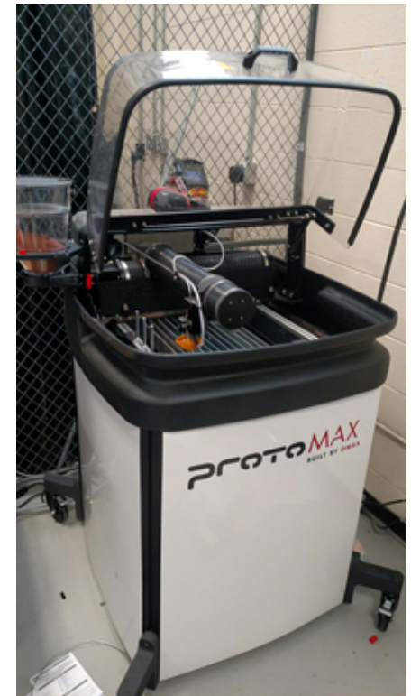
OMAX ProtoMAX waterjet 12"x12"
